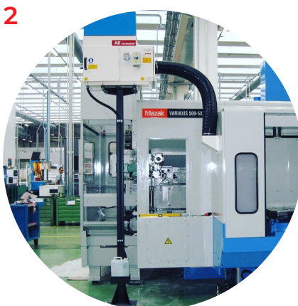
MONTAŻ NA SŁUPIE ZAKOTWIC- ZONYM W POSADZCE
